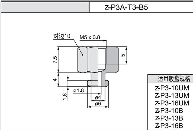
真空吸盘ZP系列组合结构图表 - 安装螺钉 - 迷你型
